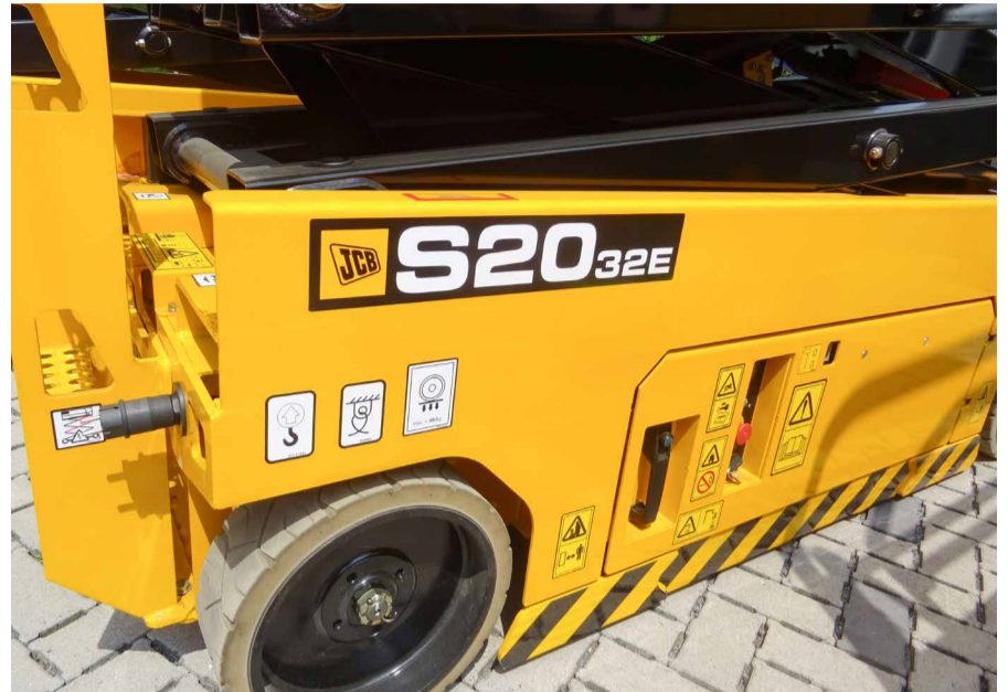
Deze schaarlift reikt 20 feet hoog en het platform is 32 inches breed. De 'E' staat voor elektrisch, dat spreekt voor zich.
